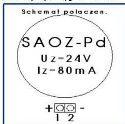
Schemat połączeń sygnalizatora SAOZ-Pd
