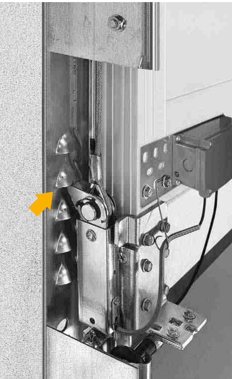
Zatrask ryglujący w kształcie haka blokuje się automatycznie przy próbie podważenia bramy.
