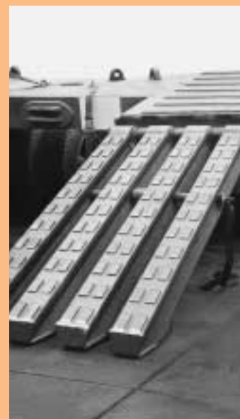
Różne pokrycia niecek kołowych pojazdów niskopodłogowych
