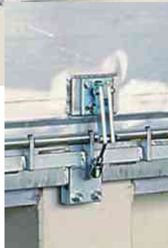
Zabezpieczenie przed opadnięciem
