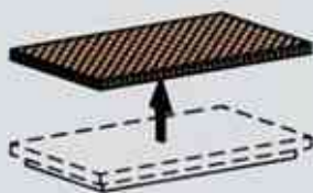
Platforma z blachy ryflowanej
