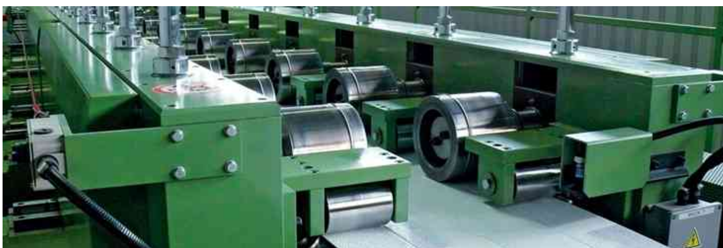
Początek produkcji paneli - kształtowanie blachy
