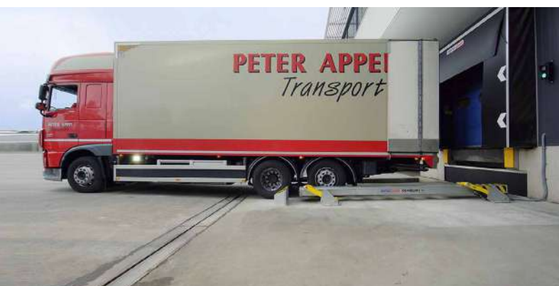
Duża średnica koła, podwójna oś i "boczna belka przeciwnajazdowa"
